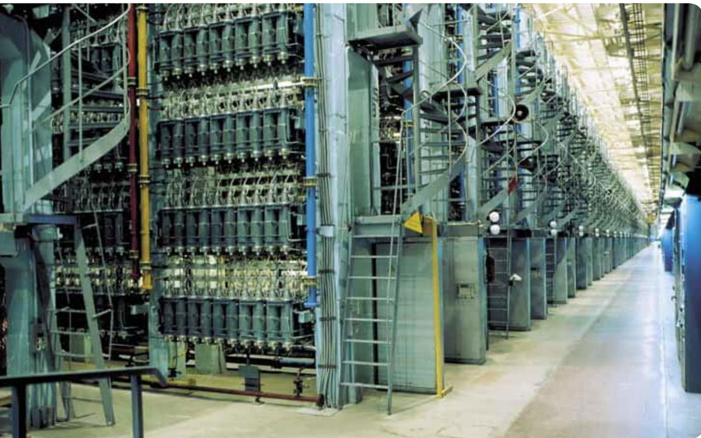
Разделение изотопов урана U-235 и U-238 с образованием обогащенного и обедненного газовых потоков гексафторида урана происходит в центрифугах. Центрифуги соединены коммуникациями в общую систему, коэффициент полезного действия которой, практически, приближается к ста процентам
