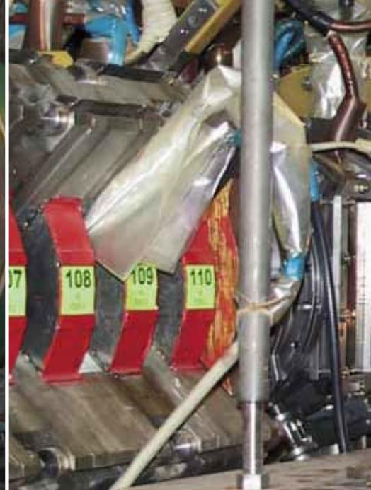
Выходной узел многопробочной ловушки ГОЛ-3
