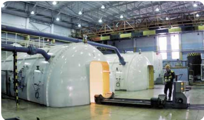
Цех для разлива и упаковки готовой продукции. Наполнение контейнеров товарным гексафторидом урана-235 производится в его жидком агрегатном состоянии в специальных установках под названием «челнок» с последующей его кристаллизацией и упаковкой для транспортировки
